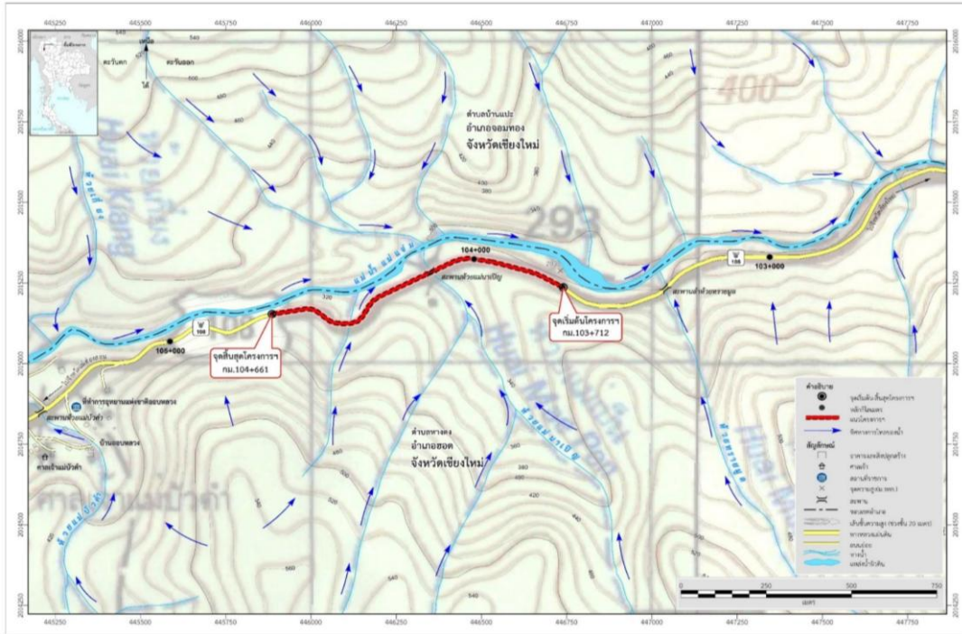
รูปที่ 5-12 ทิศทางการไหลของการระบายน้ำในพื้นที่โครงการ
