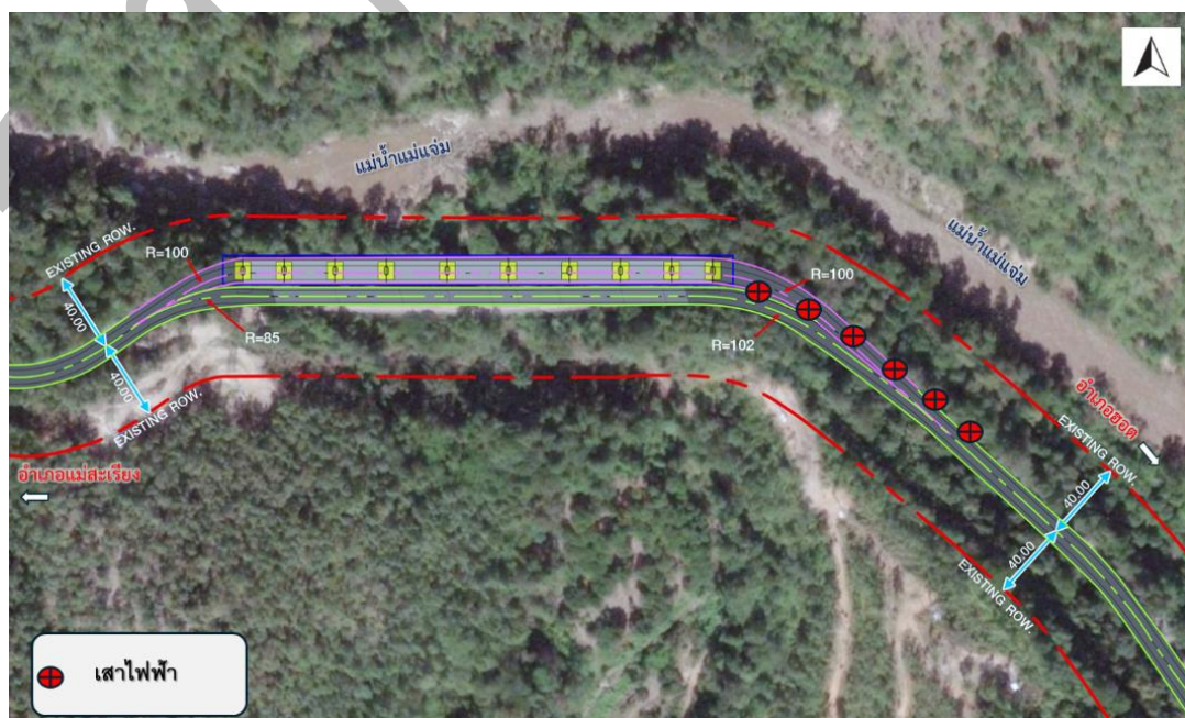
รูปที่ 5-13 เสาไฟฟ้าบริเวณพื้นที่โครงการที่ต้องรื้อย้าย
